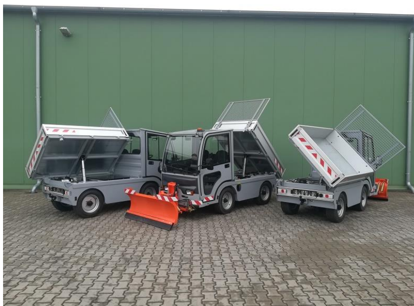
Rysunek 14 Pojazd elektryczny /wersja wywrotka/
