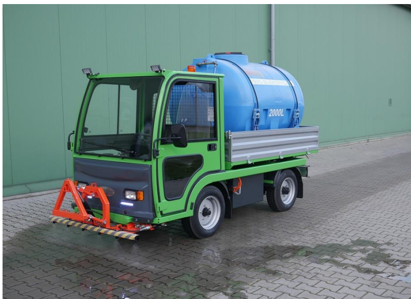
Rysunek 13 Pojazd elektryczny /wersja polewaczka/
