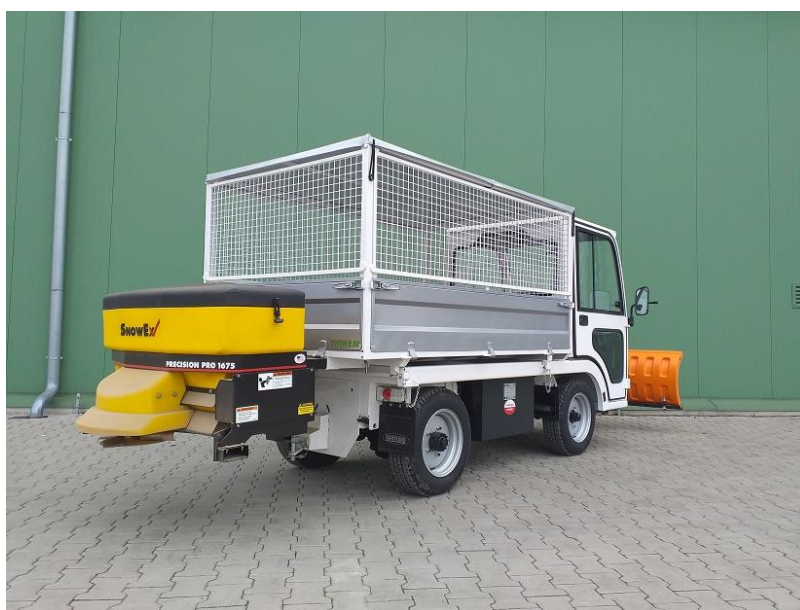
Rysunek 12 Pojazd elektryczny /wersja plug i posypywarka/
